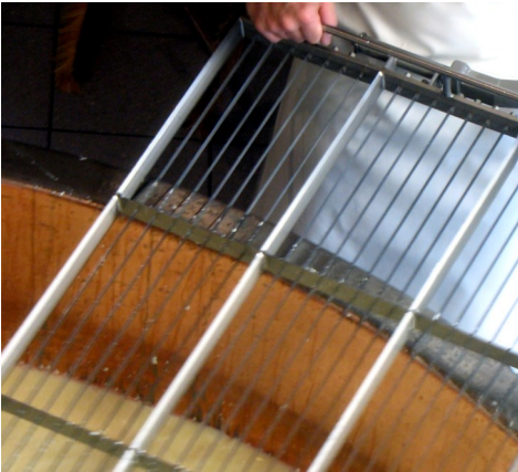
Tranche-caillé : appareil qui découpe le caillé pour en accélérer l'égouttage.
